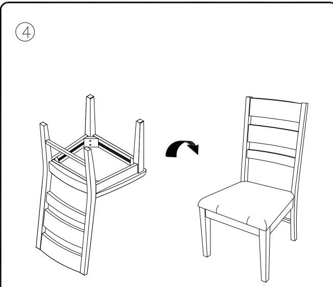
NOTE: Level the chair and tighten all bolts with the allen wrench. NOTA: Nivele la silla y aprete todos los pernos con la llave allen. REMARQUE: Mettez la chaise droite et serrez tous les boulons avec les clés allen. 注意: 如果发现椅子不稳,请用内六角扳手拧紧所有螺杆。
